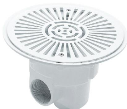
Realizzato totalmente in ABS bianco, attacco inferiore da 1½ " e attacchi laterali da 2 " che possono essere inseriti dall'interno per prove di pressione. Attacco inferiore 1 1/2 " con tappo o per il montaggio della valvola di sicurezza idrostatica e del tubo di drenaggio. Portata massima: 13 m<sup>3</sup> / h.
