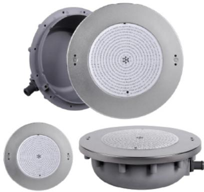
VRL327 è una lampada da incasso per piscina con nicchia per piscina in cemento, che utilizza una sorgente luminosa SMD2835 e materiale per lenti per PC. Le sue opzioni di alimentazione sono 18W, 25W, 35W e 40W.
