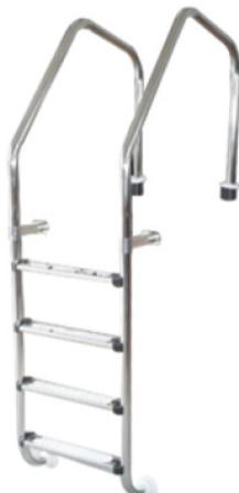
Corrimano in tubo di acciaio inossidabile 316 ( $\varnothing 42\text{mm}$ ) lucido. Lo spessore del tubo è di 0,9 mm per A e 1,1 mm per B. Ogni modello di scala è disponibile in due diversi stili di gradini; Battistrada standard in acciaio inossidabile e battistrada in plastica antiscivolo. Ogni gradino della scala può essere fornito con 2,3,4 o 5 gradini.
