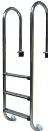
Corrimano in tubo di acciaio inossidabile 316 lucido ( $\varnothing 42\text{mm}$ ). Lo spessore del tubo è 0,9 mm per A e 1,1 mm per B. Ogni modello di scala è disponibile in due diversi stili di gradini; Battistrada standard in acciaio inossidabile e battistrada in plastica antiscivolo. Ogni gradino della scala può essere fornito con 2,3,4 o 5 gradini.
