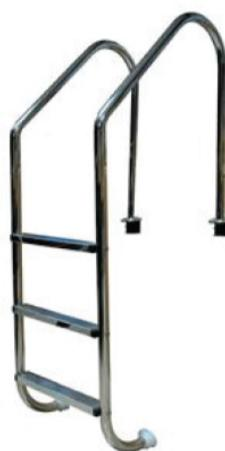
Fabbricato in tubo di acciaio inossidabile 316 con diametro 42 mm, spessore 0,9 mm e 1,1 mm. Ogni modello di scala è disponibile in due diversi stili gradino: gradino in acciaio inossidabile standard e gradino in plastica antiscivolo. Ogni stile scala può essere fornito con 2, 3, 4 o 5 gradini.
